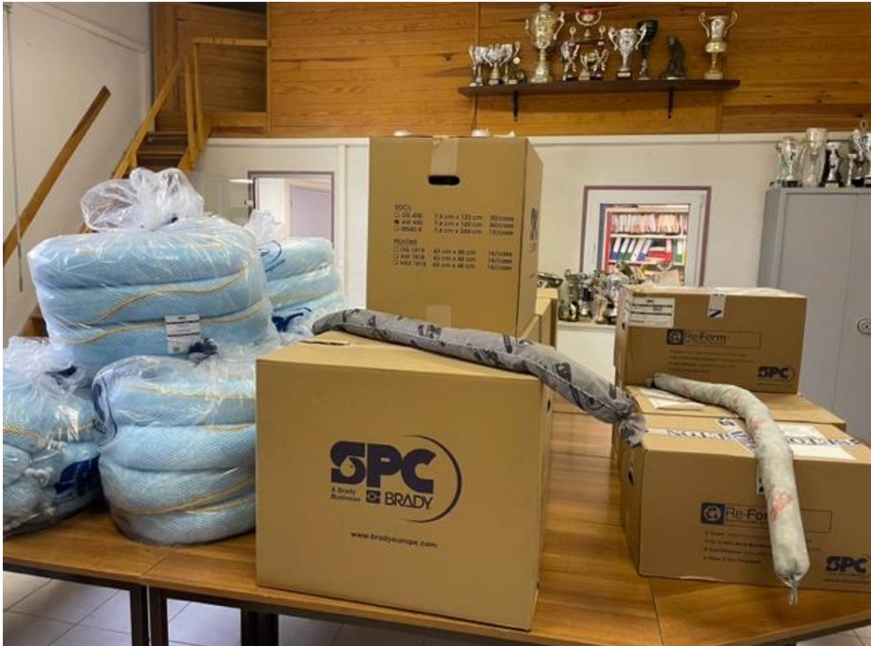
Figure 4. Photo des différents boudins reçus à l'AAPPMA (de gauche à droite : barrage absorbant spécifique hydrocarbures, boudin tous liquides et boudin écologique tous liquides)
