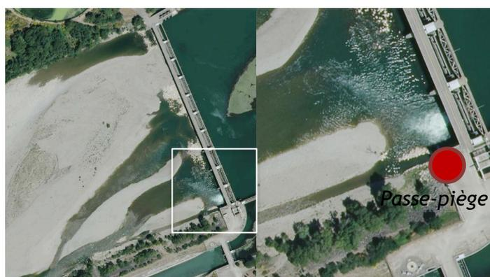
Figure 5 : Barrage EDF de Mallemort (Géoportail) et localisation de la passe-piège
