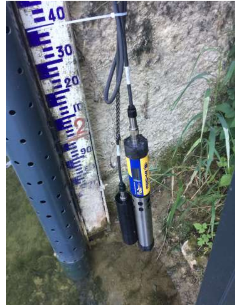
Capteur qualité/O 2 (taille réelle : 592 mm x 47 mm)
