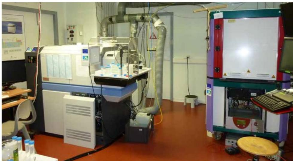
*Le spectromètre de masse à plasma induit*
